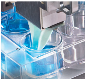
「8 対 1」チップにより、バルク試薬分注で 6 ～ 24 ウェルプレート の 1 個または複数のウェルに分注できます。
