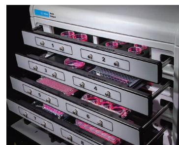
Agilent BioTek BioSpa 8 全自動インキュベーターは同時に最大 8 のマイクロプレートやその他のラボウェアを処理可能です。
