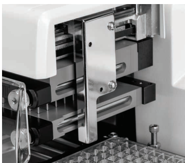
Agilent BioTek Verify モジュールはマニホールドの上に組み込まれており、分注および吸引サイクル後に各ウェルの液量を測定します。
